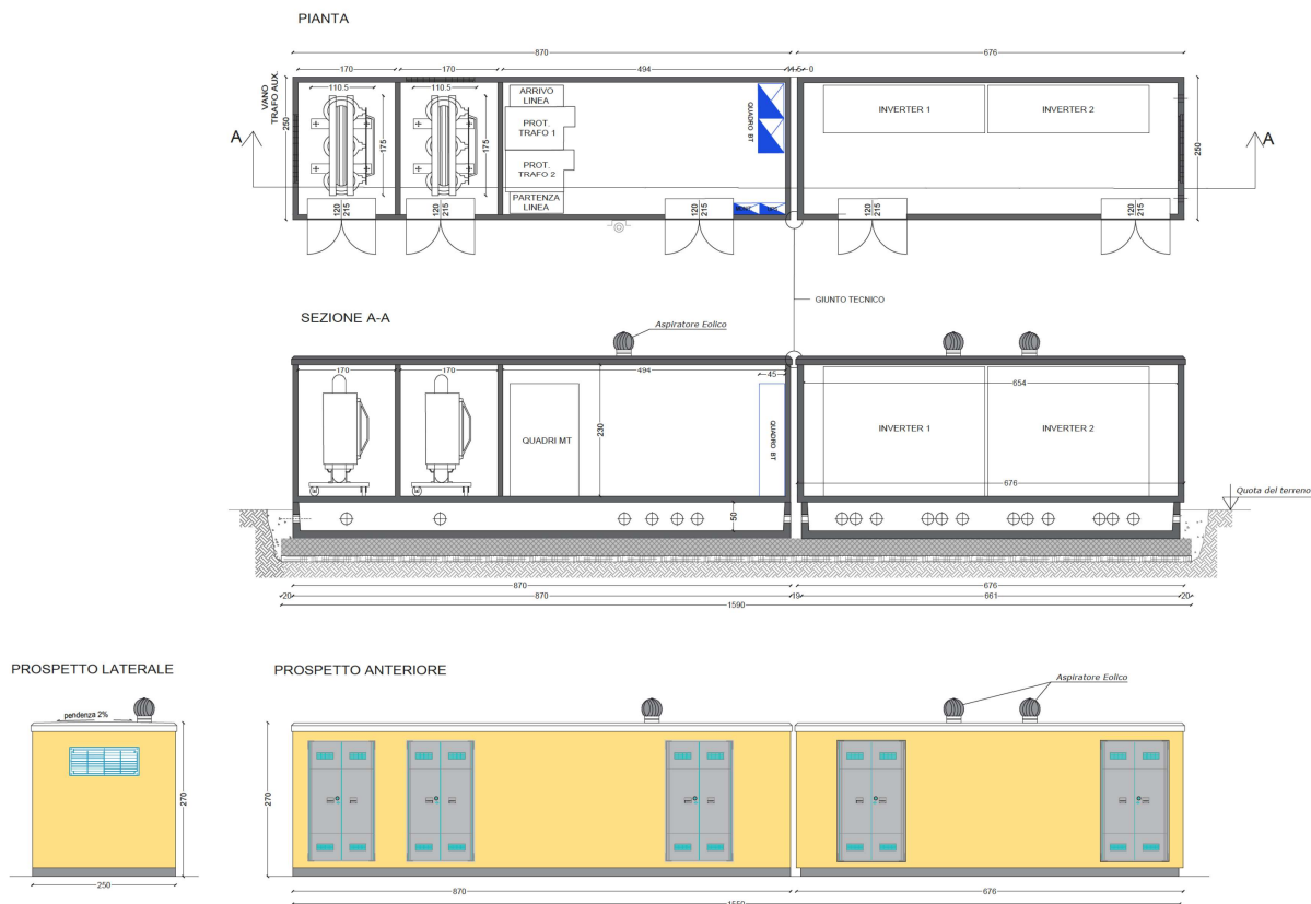
Figura 3.2-1 – Planimetria e prospetto Power Station
