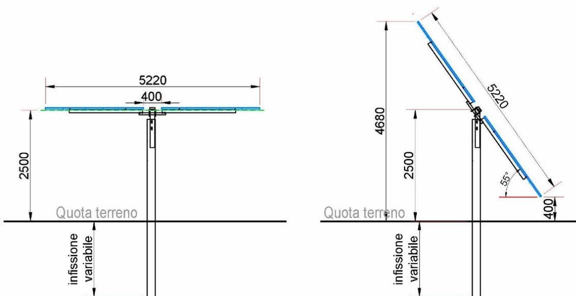
Figura 3: viste laterali delle strutture di sostegno dei pannelli.
