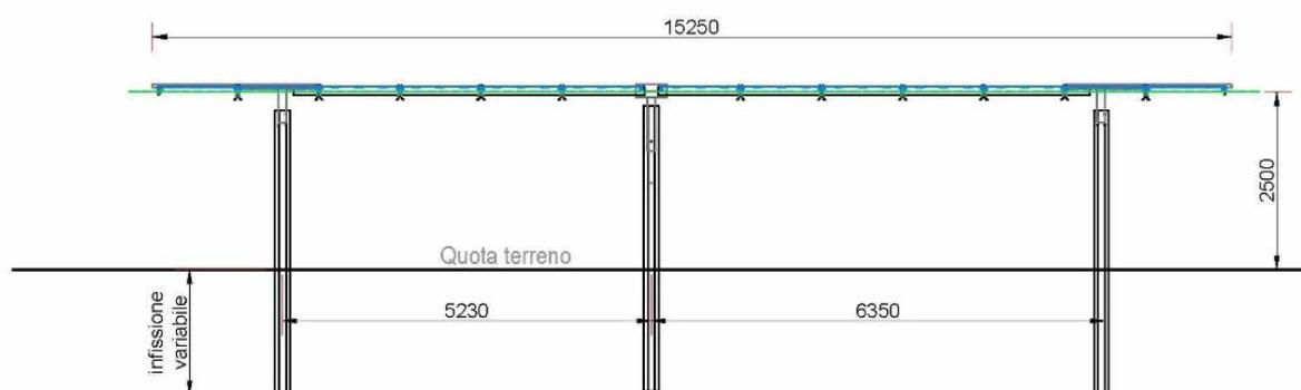
Figura 1: tipologico struttura sostegno moduli – prospetto.
