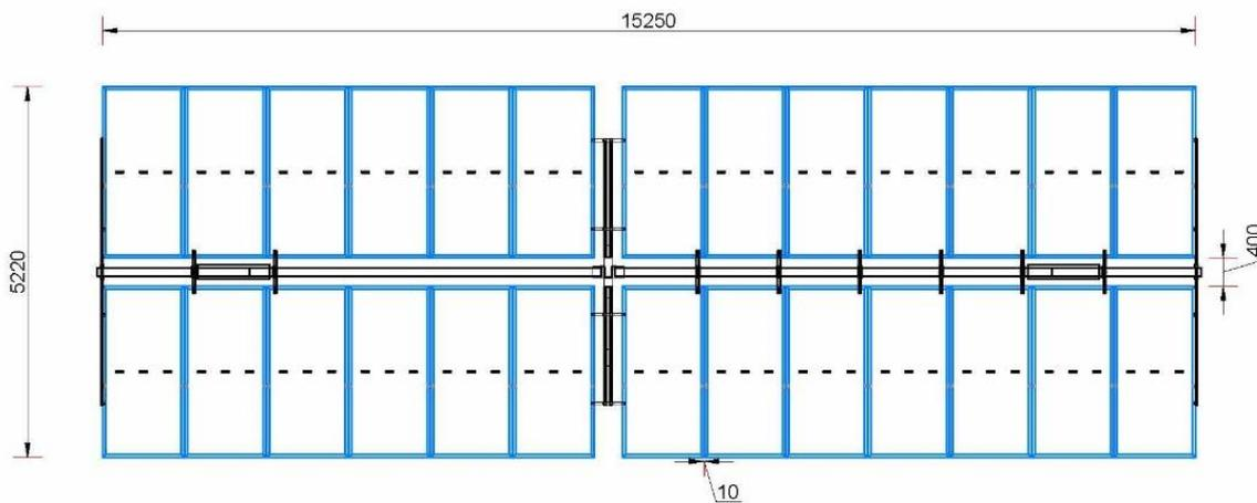
Figura 2: tipologico struttura sostegno moduli – pianta.
