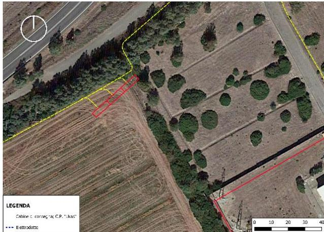
Figura 36 - Sito di realizzazione delle cabine di consegna e ultimo tratto di cavidotto. In basso a destra: C.P. "Uras"
