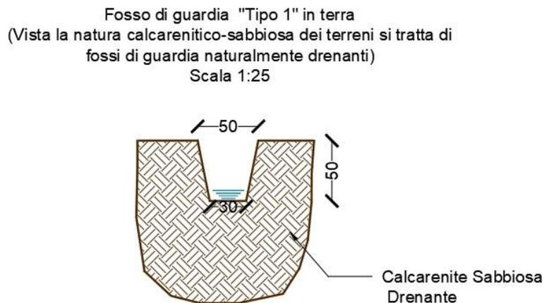
Figura 16: tipologico fosso di guardia drenante di progetto.
