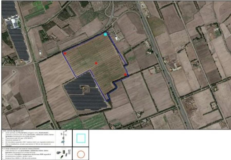
Foto n.1: Ortofoto indicante il posizionamento della unità centrale ed il posizionamento delle n. 3 unità wireless con IoT e sensori meteo-climatici
