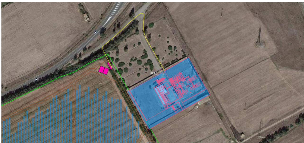
Fig. 6.1 – Cavidotto (in giallo)
