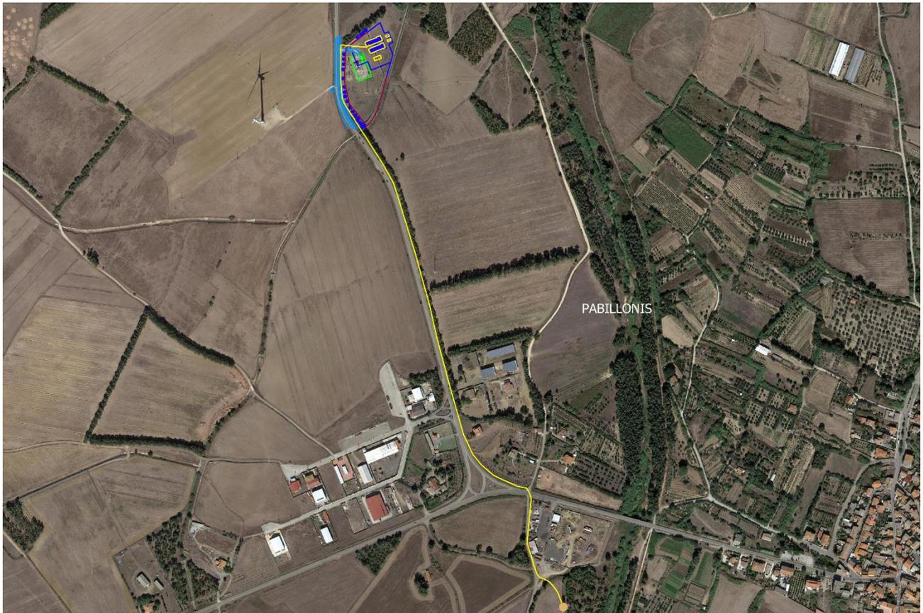
Fig. 7 – Area di Pabillonis: ampliamento cabina elettrica e cavidotto interrato.
