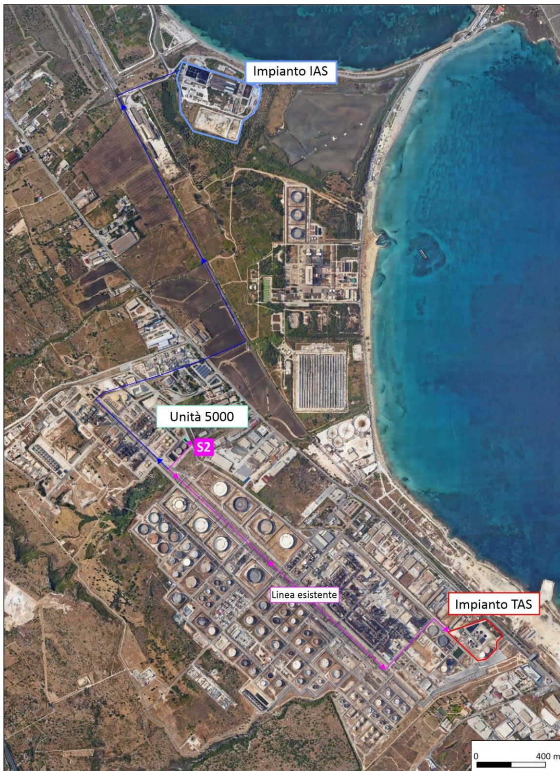
Figura 2: Assetto futuro: invio scarico idrico S2 dell'unità U5000 dell'impianto IGCC in parte a TAS e in parte a IAS
