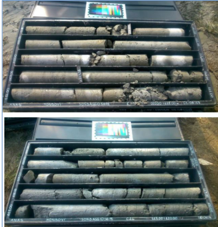
Figura 7.34 Sondaggio S08 tra 110 e 120 m, all'altezza della galleria naturale
