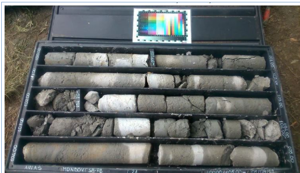
Foto 4.5 Arenarie (della F.ne di Lequio) nel sondaggio S8-Pz fra 100-105 m da p.c.
