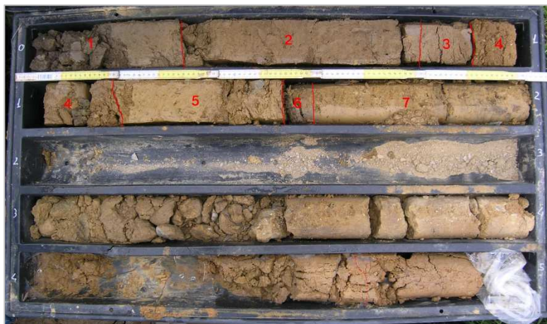
Figura 49 Area 2: sondaggio SD13-i. Sequenza stratigrafica
