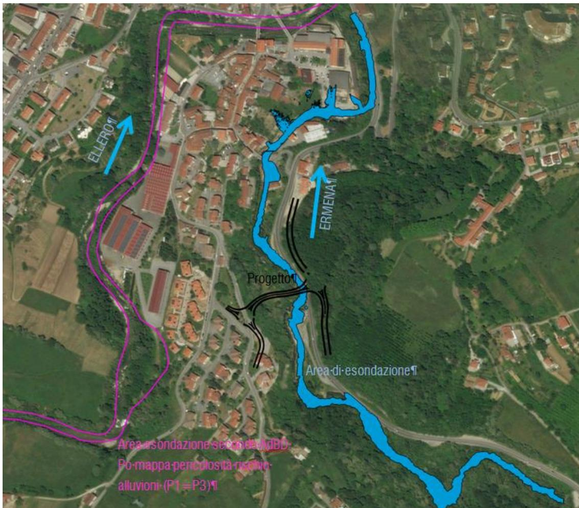
Figura 3.12: Area di esondazione modellata del torrente Ermena con  $Q_{Tr200}=112 \text{ m}^3/\text{s}$ . Si evince l'assenza di mappatura inerente all'area di esondazione del AdBD del Po (dalla relazione idraulica di progetto)
