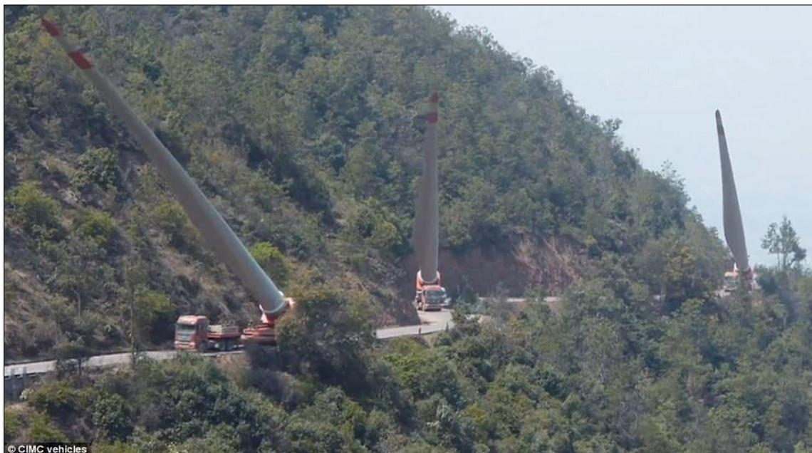
**Figura 5:** le foto mostrano il trasporto delle pale con il “blade -lifter”.
