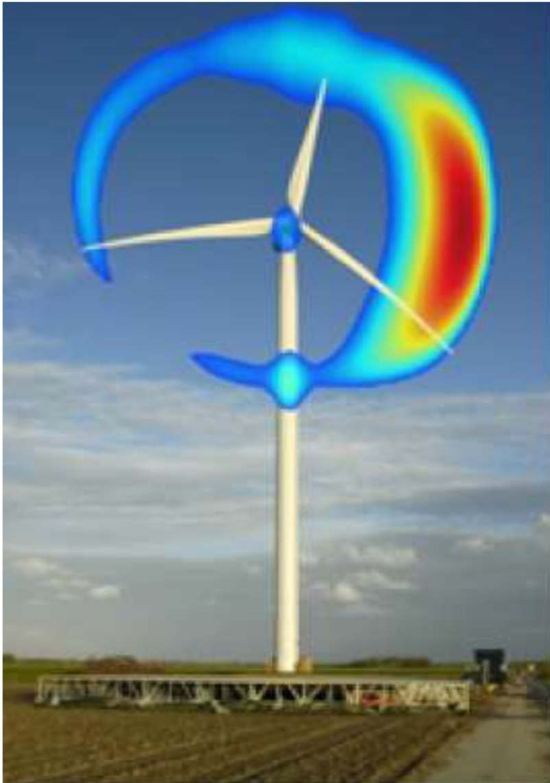
Rumore rilevato con SISTEMA BEAMFORMING
