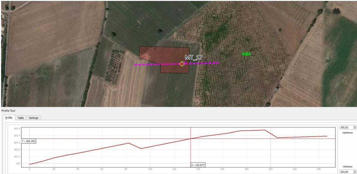
L'area di sedime dell'aerogeneratore MT\_17 è ubicata sul terrazzo alluvionale posto in destra orografica del Torrente Cigno, alla quota di 165,4 metri s.l.m.
