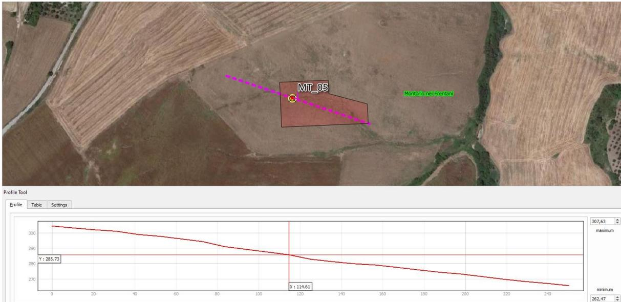
L'area di sedime dell'aerogeneratore MT\_05 è ubicata alla quota di 285,7 metri s.l.m., su un versante esposto a Sud-Est, con pendenza complessiva di circa il 18%.
