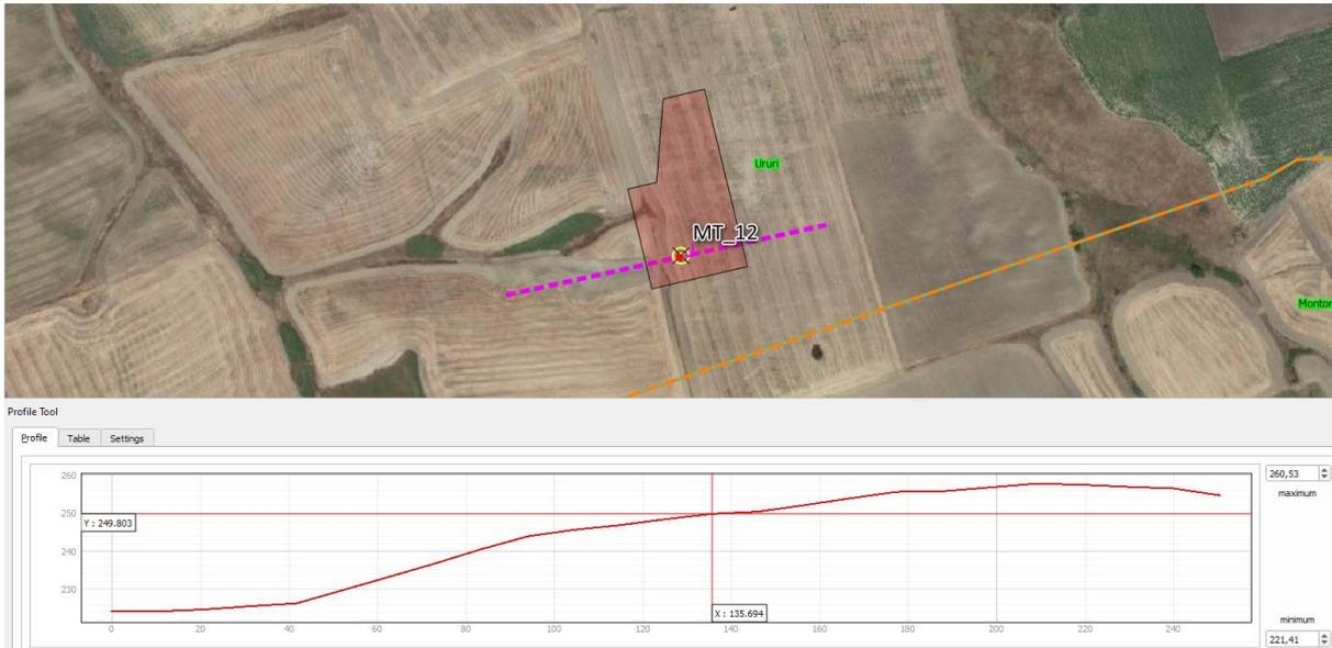
L'area di sedime dell'aerogeneratore MT\_12 è ubicata alla quota di 249,8 metri s.l.m, su un versante esposto ad Ovest, con pendenza media del 14%.
