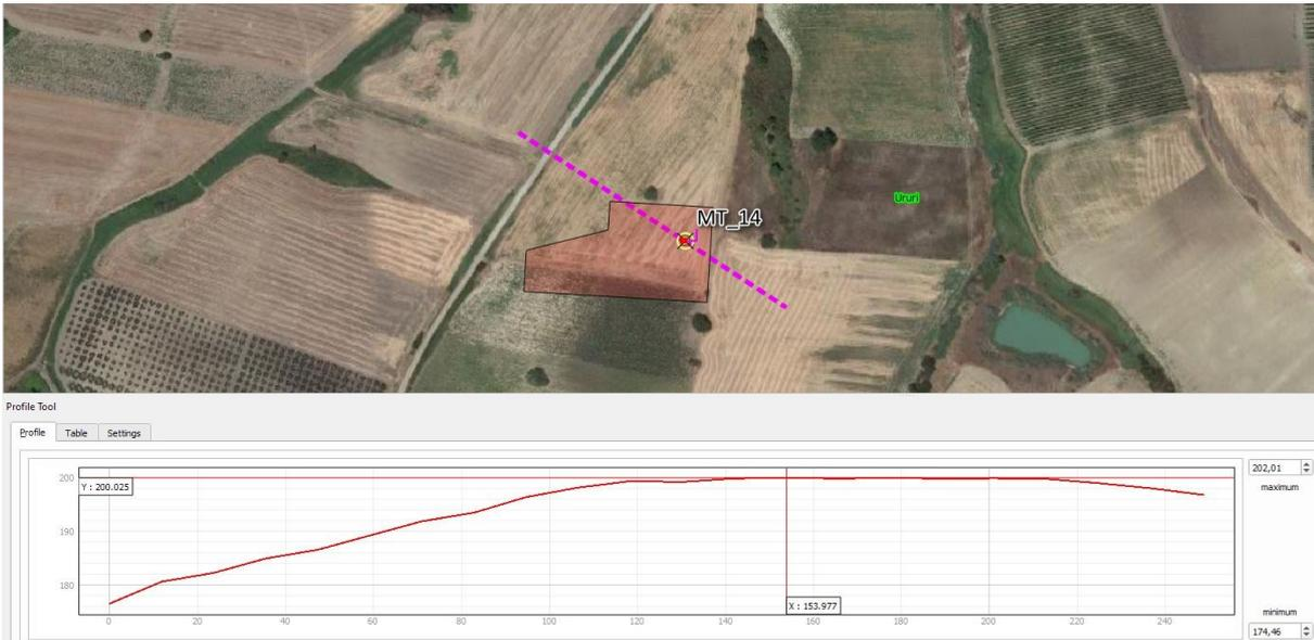
L'area di sedime dell'aerogeneratore MT\_14 è ubicata in corrispondenza di una piccola dorsale con andamento Nord-Sud, alla quota di 200,0 metri s.l.m.; la superficie topografia risulta essere sub-pianeggiante.
