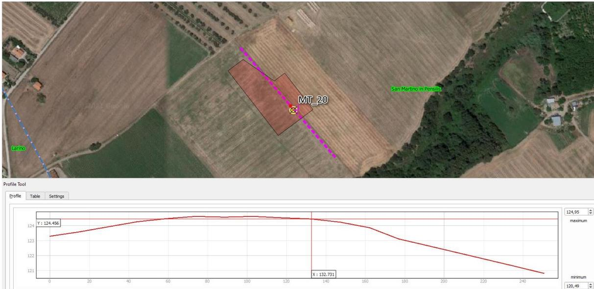
L'area di sedime dell'aerogeneratore MT\_20 è ubicata sul terrazzo alluvionale di III°ordine del Torrente Cigno, alla quota di 124,4 metri s.l.m.; per sua genesi l'area risulta essere sub-pianeggiante con pendenza verso Sud-Est.
