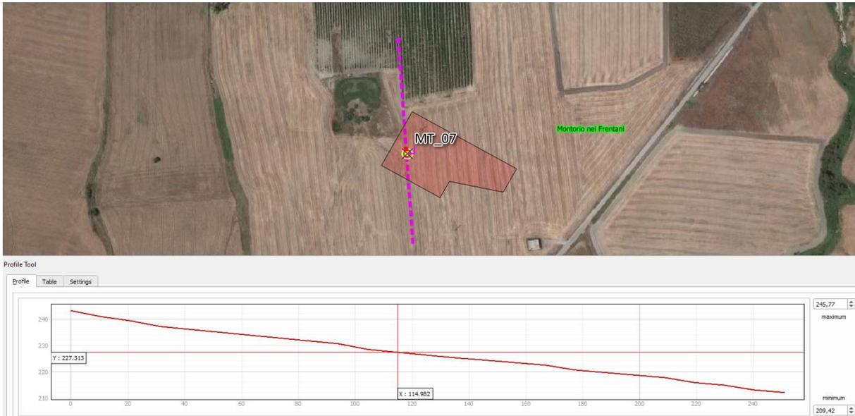
L'area di sedime dell'aerogeneratore MT\_07 è ubicata alla quota di 227,3 metri s.l.m., su un versante esposto a Nord, con pendenza complessiva di circa 14%.
