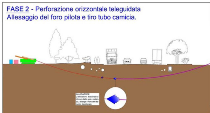
Modalità di realizzazione attraversamento in T.O.C.
