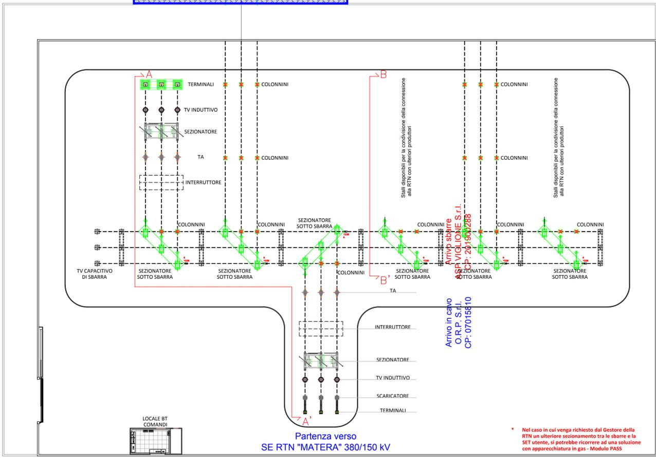
\* Nel caso in cui venga richiesto dal Gestore della RTN un ulteriore sezionamento tra le sbarre e la SET utente, si potrebbe ricorrere ad una soluzione con apparecchiatura in gas - Modulo PASS
