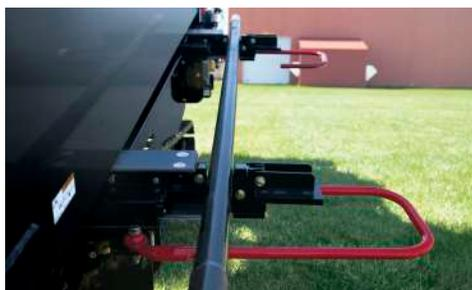
**VARIETÀ DI OPZIONI RELATIVE ALLE ASTE.** Il D40x55 S3 è disponibile con un'ampia gamma di opzioni relative alle aste di perforazione, che comprende aste lunghe 3 m con diametro di 6 cm o 6,7 cm e aste lunghe 4,6 m con diametro di 6,7 cm. La grande varietà di opzioni relative alle aste permette di configurare la macchina perforatrice in base alle specifiche esigenze del committente.
