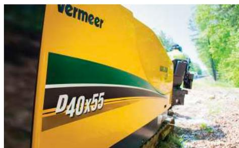
**PRESTAZIONI OTTIMALI.** Con 177,9 kN di spinta/tiro-posa e 7.457 Nm di coppia di rotazione, il D40x55 S3 presenta un aumento del 10% in termini di spinta e rotazione rispetto al suo predecessore, il D36x50 Serie II, contribuendo a massimizzare la produttività.
