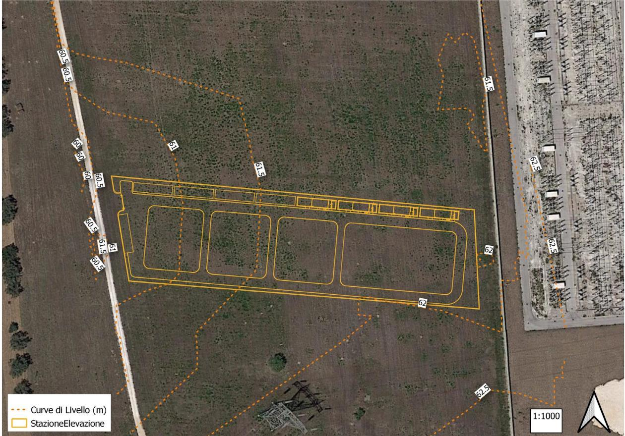
Area della stazione di elevazione in progetto con curve di livello
