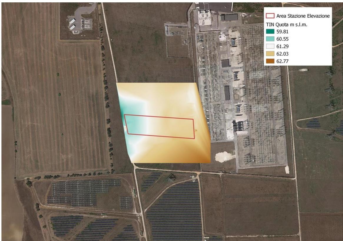
TIN derivante dal rilievo condotto – Area della Stazione di Elevazione in progetto
