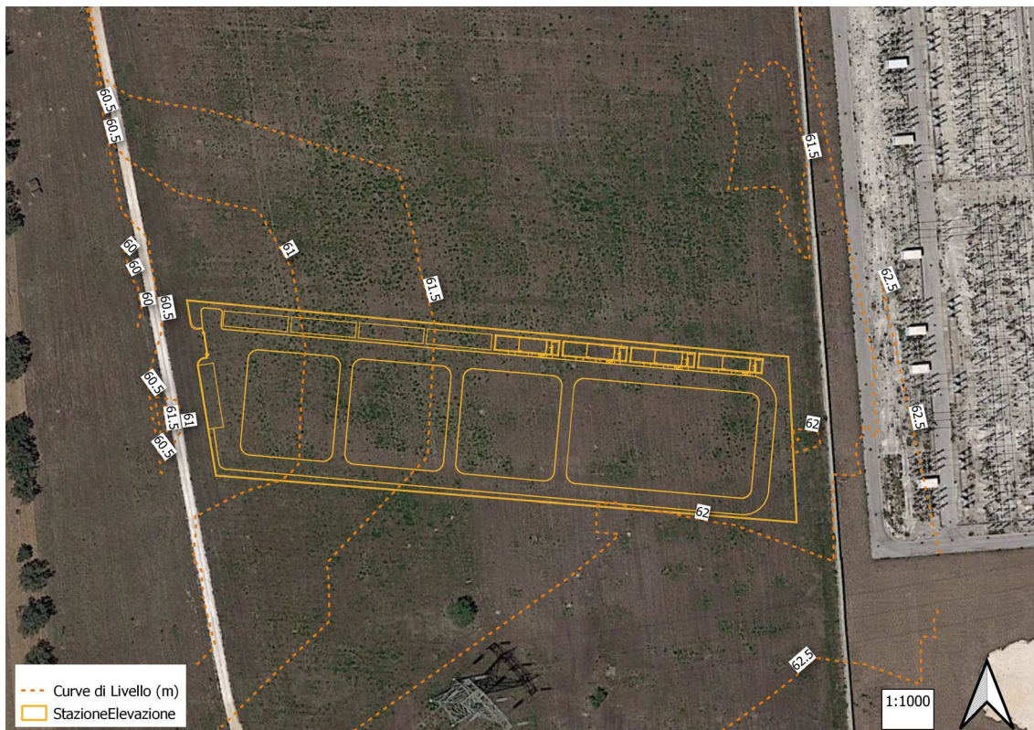
Figura 2: Quote terreno e dislivelli nell'area del sito per la realizzazione della stazione di elevazione
