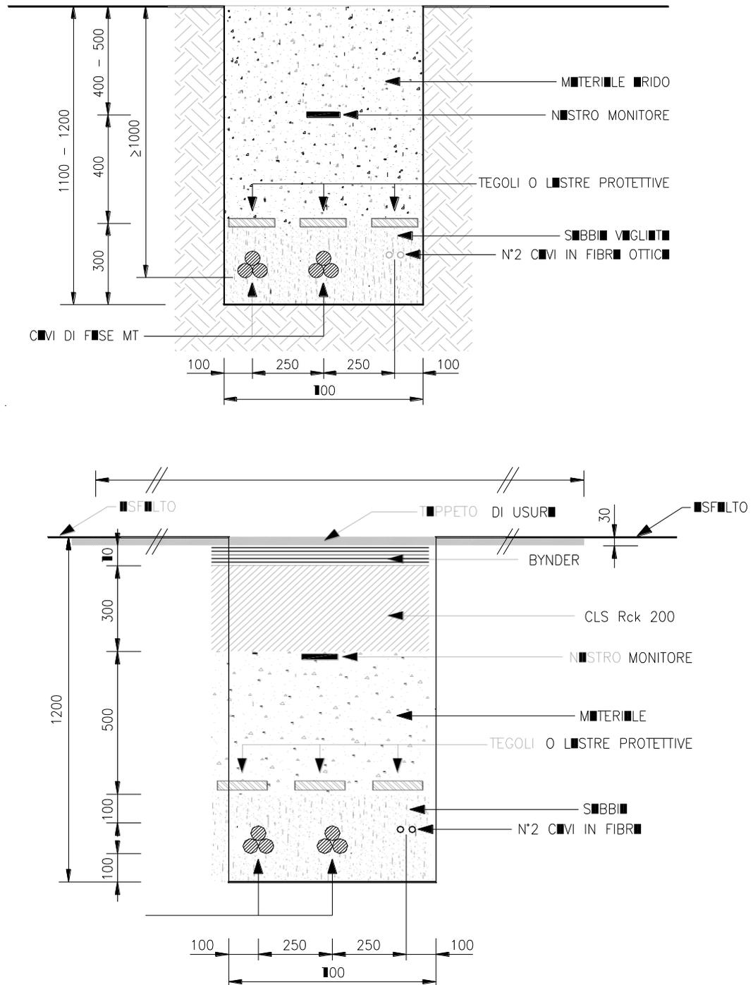
Figure: Sezioni trincea di scavo per la posa dei cavi da 30 kV di collegamento dall'impianto FV alla Stazione di Elevazione
