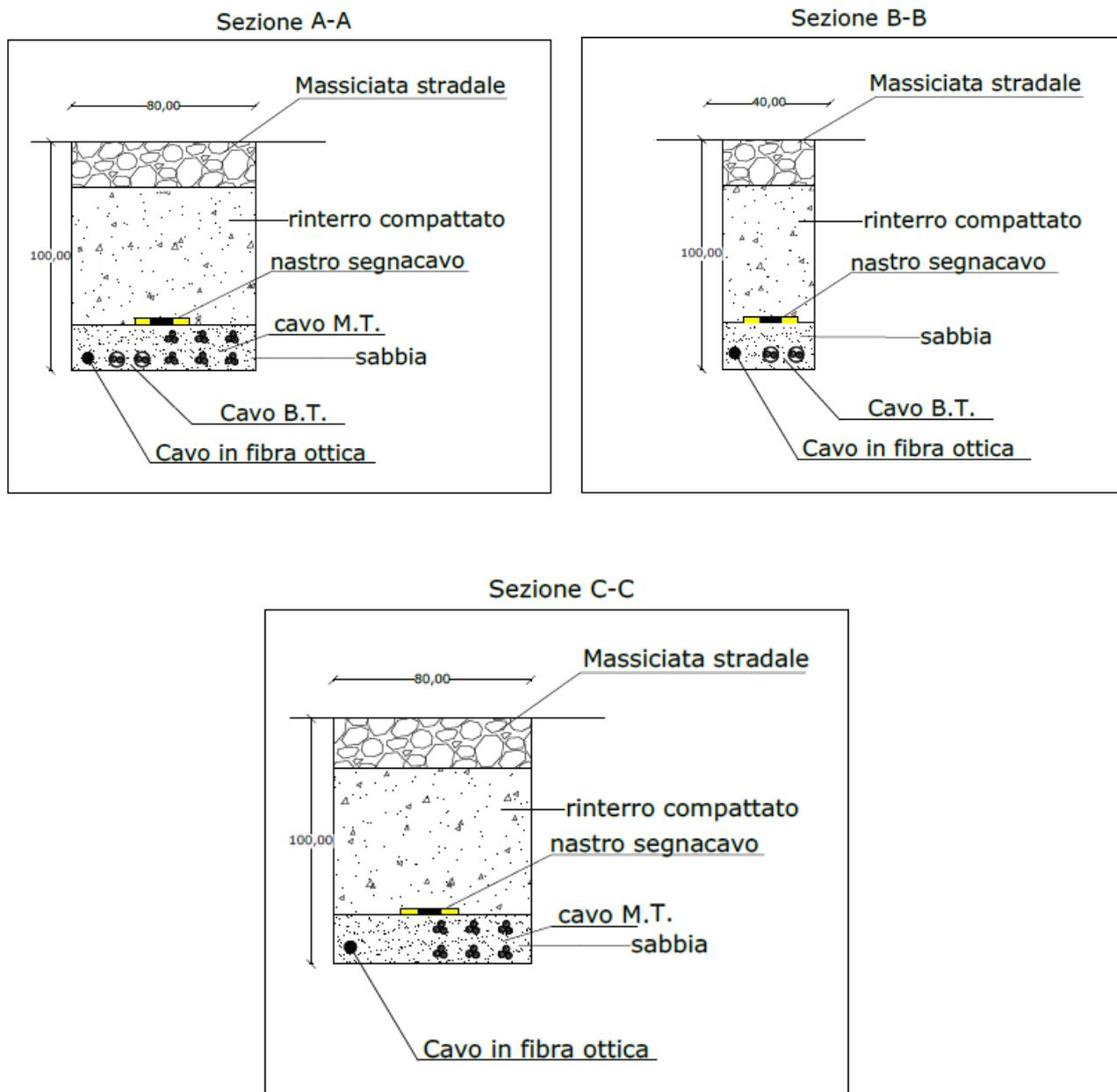
La sezione di scavo verrà parzialmente reinterrata con il materiale di risulta. Tutti i corrugati saranno immersi in uno strato di sabbia di adatte caratteristiche termiche di uno spessore di 30 cm e separati dallo strato di rinterro con una protezione meccanica.
