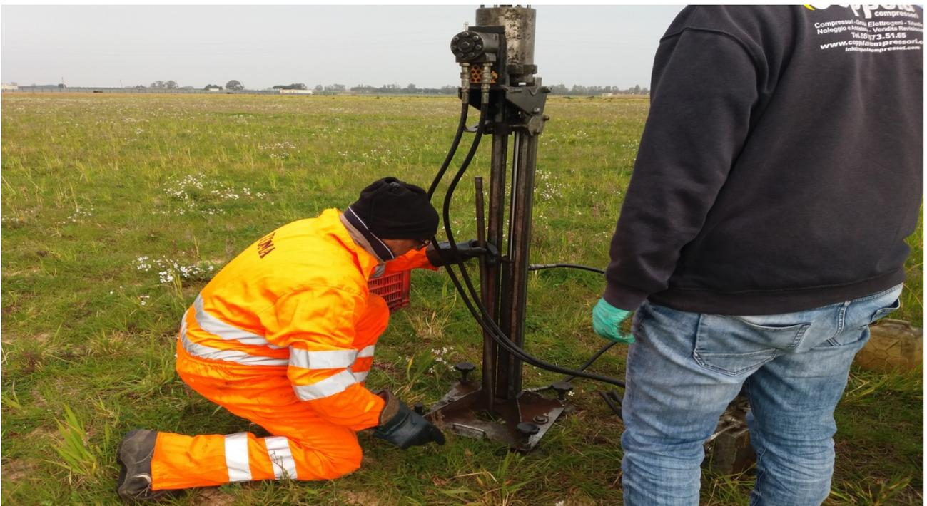
Prova Penetrometrica Dinamica – DIN 2
