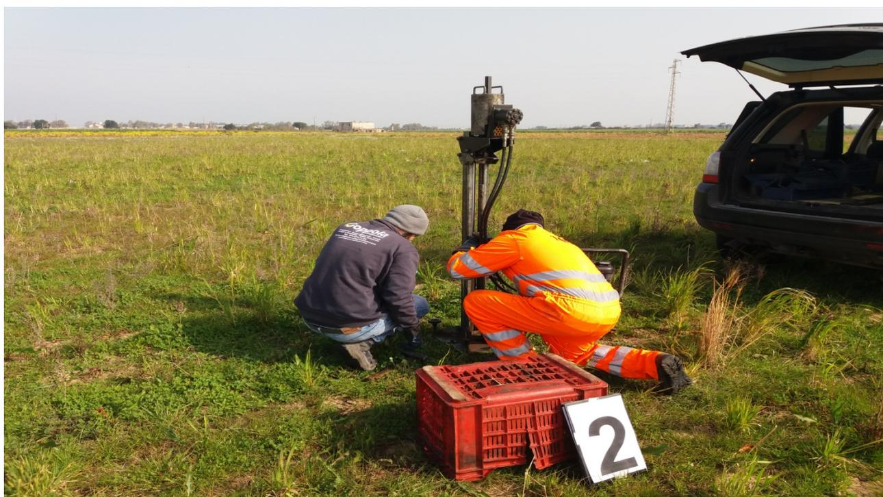
Prova Penetrometrica Dinamica – DIN 3
