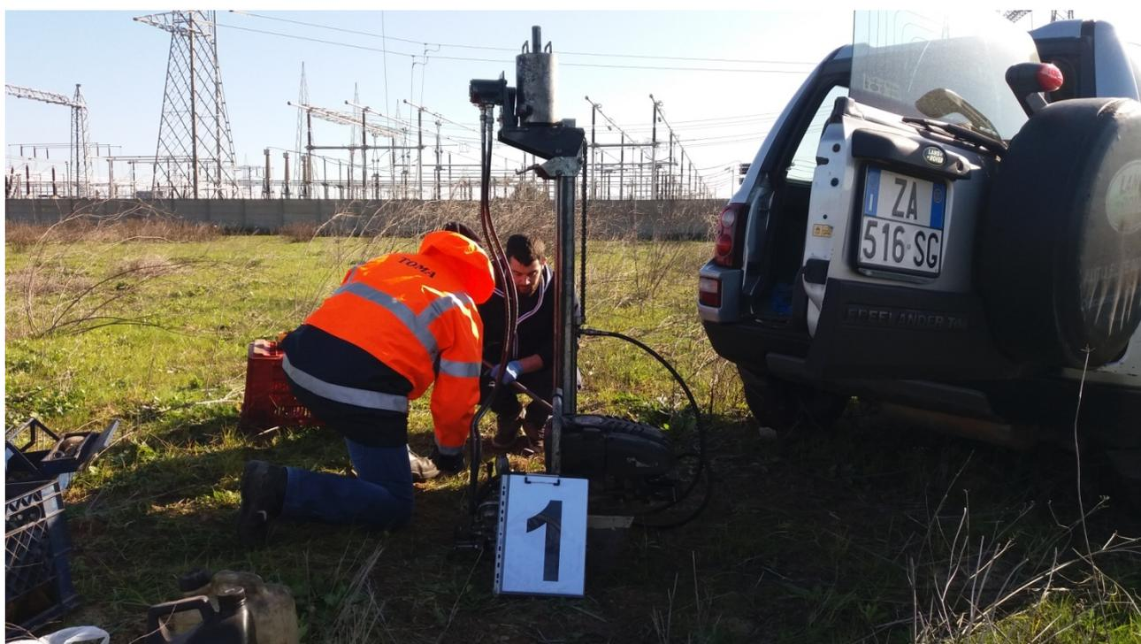
Prova Penetrometrica Dinamica denominata **DIN2**
