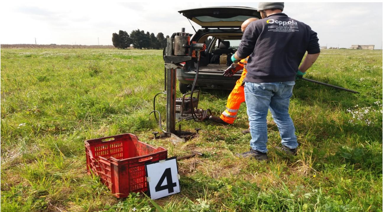
Prova Penetrometrica Dinamica – DIN 5
