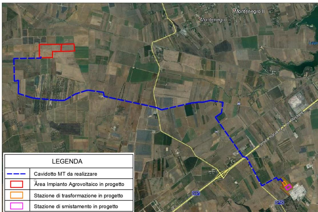
Figura 9: Inquadramento totale su mappa ortofoto dell'intera area di progetto (area impianto agrovoltaico - tracciato cavidotto – area stazioni elettriche) fino al raggiungimento della stazione Terna esistente.
