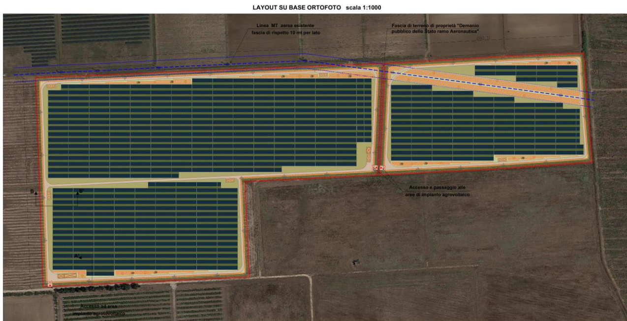
Figura: Layout del progetto definitivo dell' impianto agrovoltaico "Baroninuovi" su base ortofoto (tavola: BAN_46_Elaborato grafico_layout impianto).
