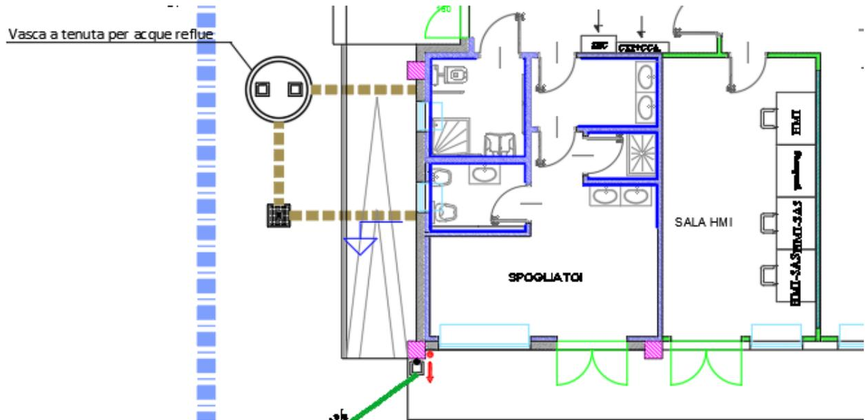
Figura 1: Planimetria della rete smaltimento acque reflue
