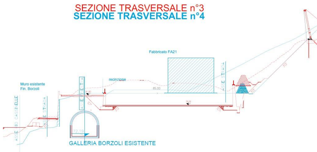
Figura 3 – Piazzola IN21 – Sezione trasversale di confronto tra progetto approvato (blu) e progetto in variante (rosso)
