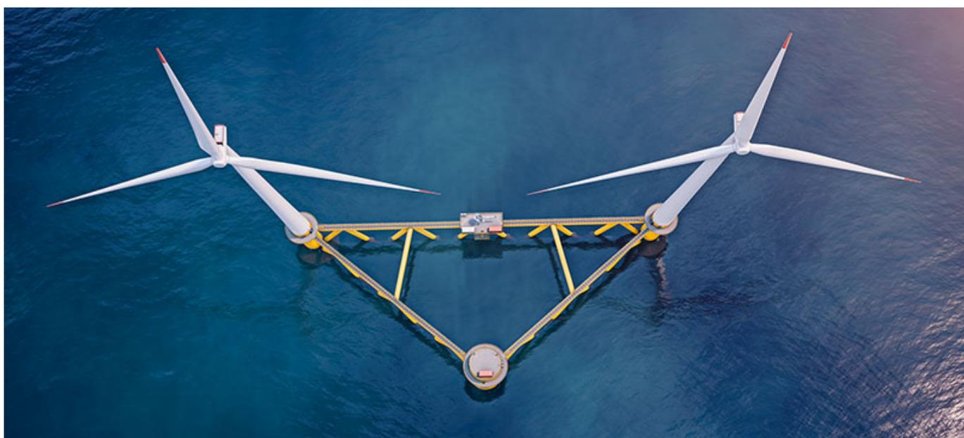
**Figure 21/22 – Struttura di fondazione galleggiante con doppio aerogeneratore**
