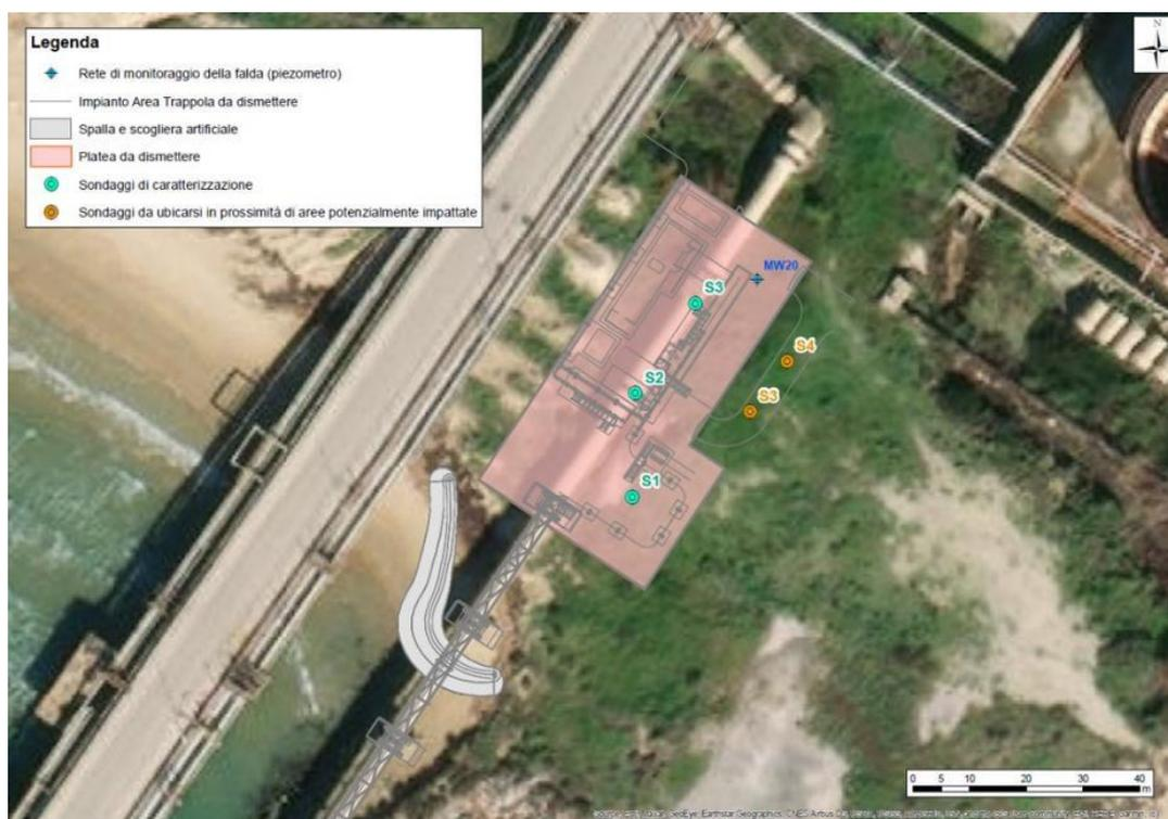
**Figura 4-4: Possibile ubicazione dei punti di caratterizzazione ambientale in area trappola, post attività di dismissione**
