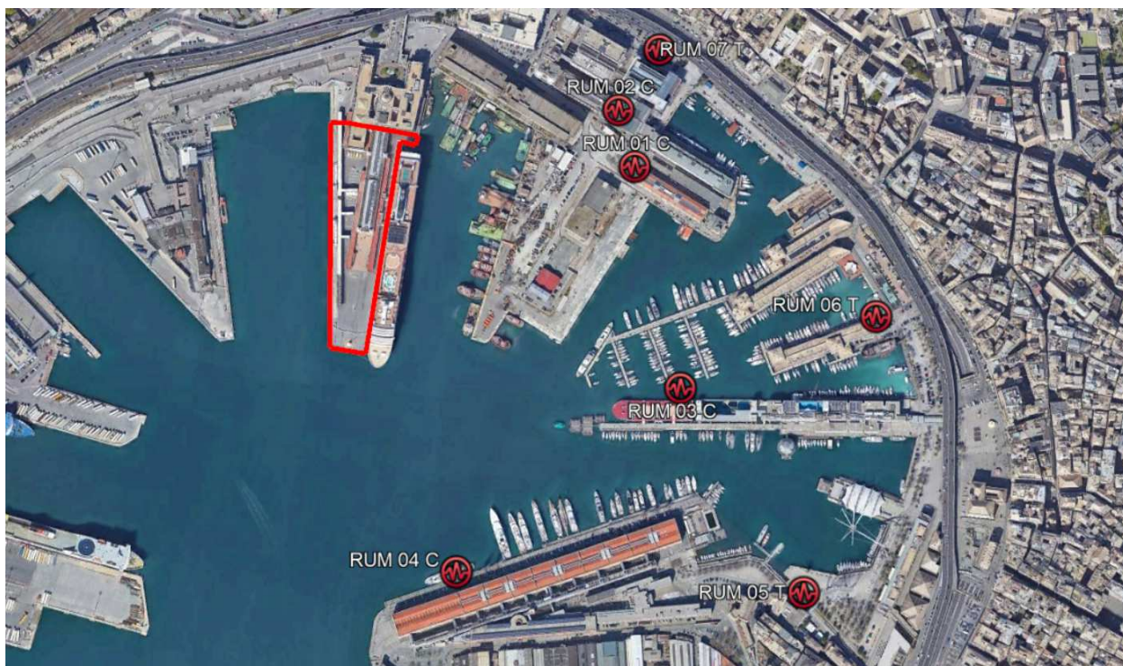
Figura 11: posizionamento delle stazioni di monitoraggio del rumore.
