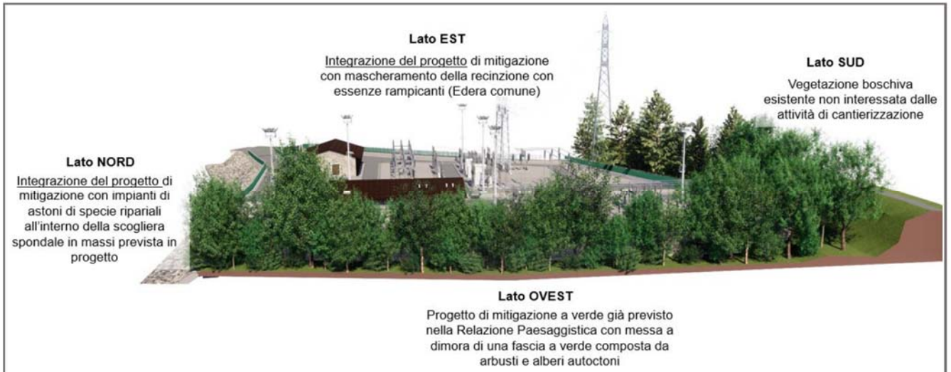
Figura 7 – Modellazione 3D dell'area SE Terna e SSE utente SRG con gli impianti e le mitigazioni a verde prima delle integrazioni effettuate con il presente progetto di mitigazione
