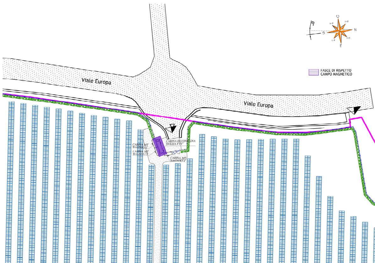
Figura 5 - Particolare cabina di consegna "SVEZIA FTV"
