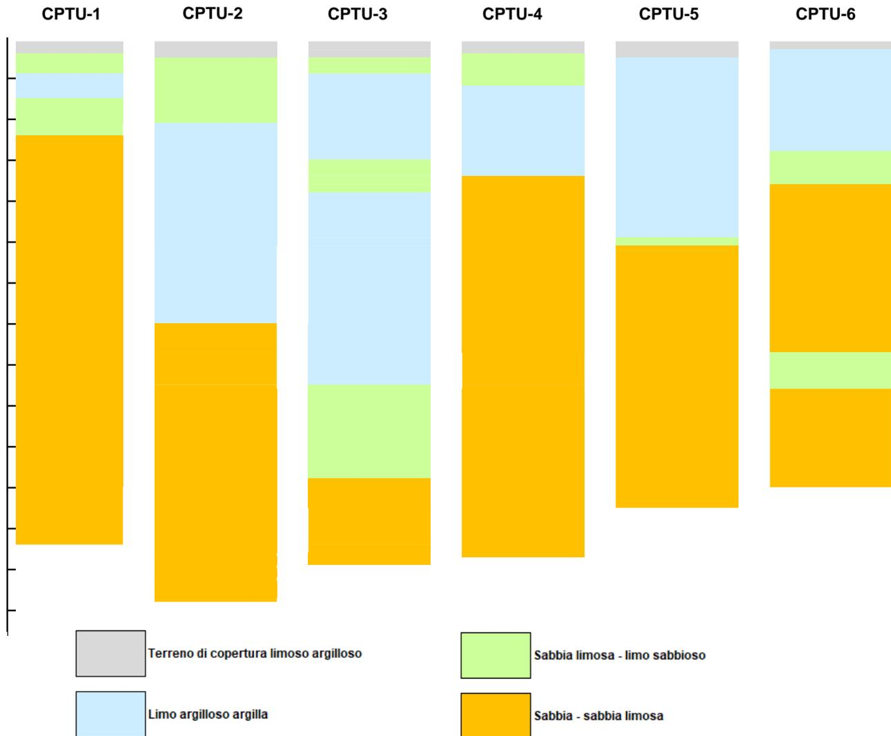
Figura 6-6 - Schema delle unità litologiche riconosciute nel sottosuolo investigato
