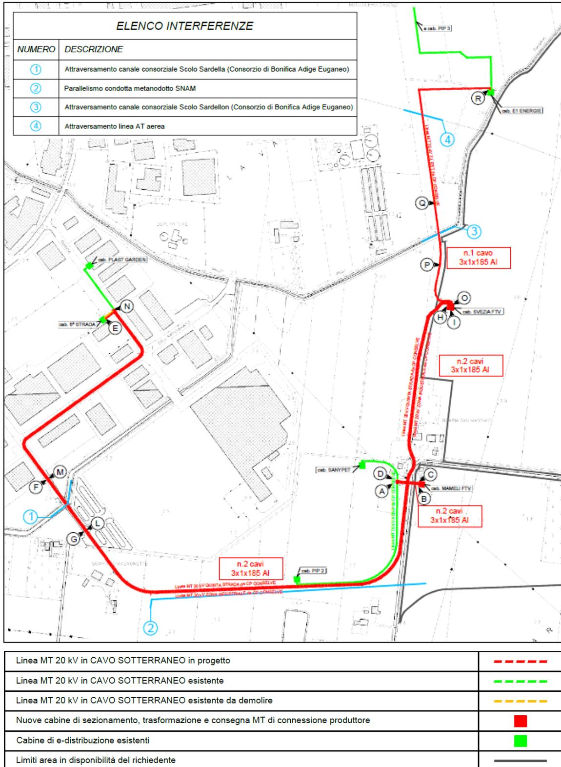
Figura 5-2 – Tracciato elettrodotto di progetto (Tavole di progetto)
