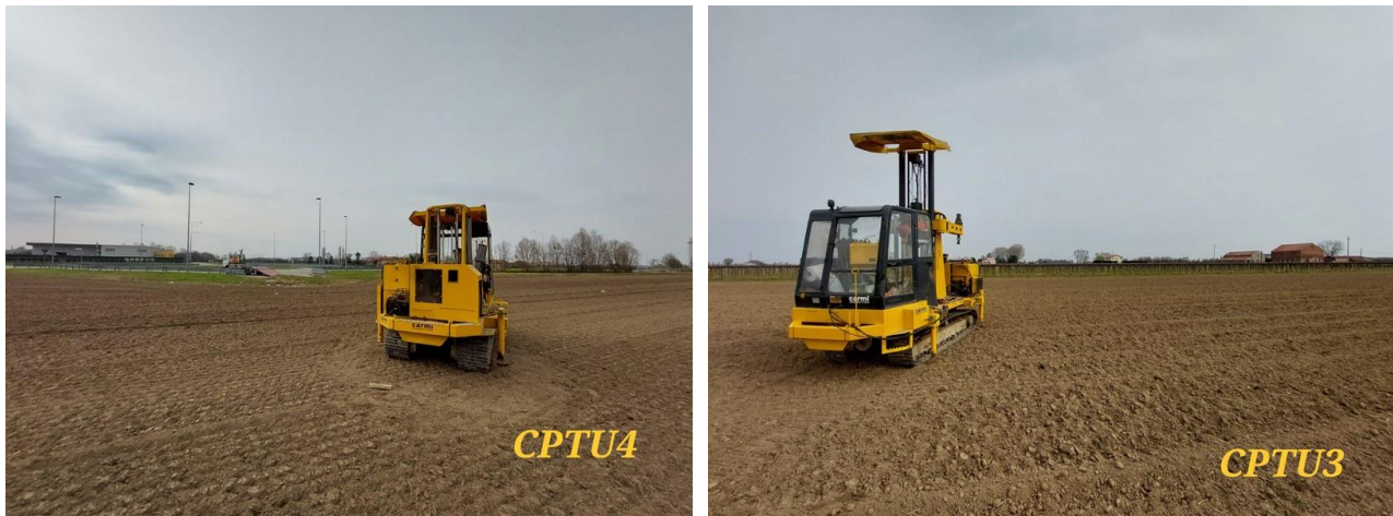
Figura 5-2 - Mezzo utilizzato per le prove CPTU
