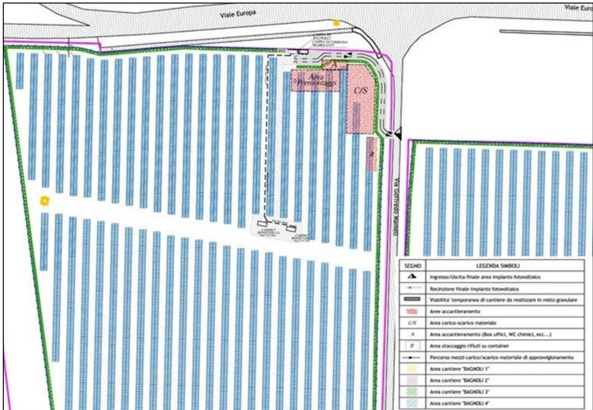
Figura 3-11 - Aree di cantiere impianto BAGNOLI 1
