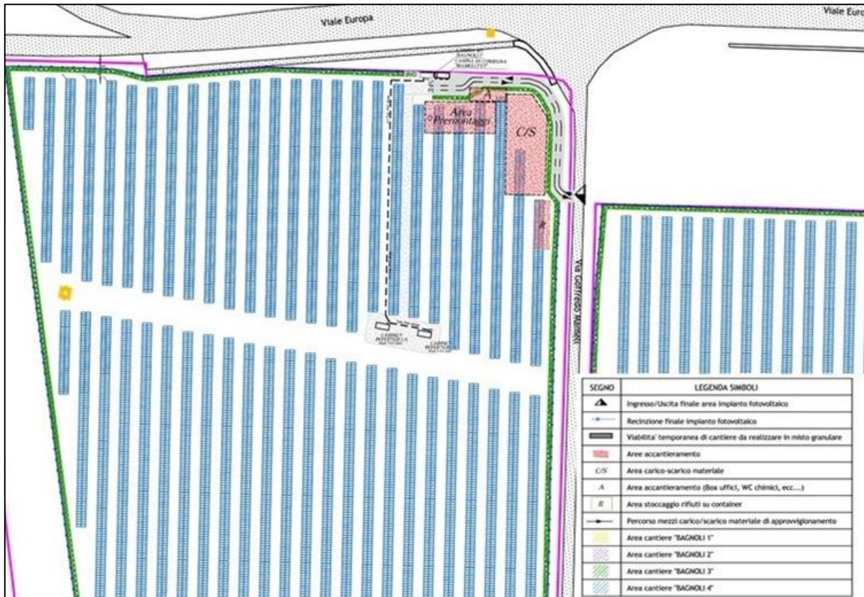
Figura 2-7 - Aree di cantiere impianto BAGNOLI 1
