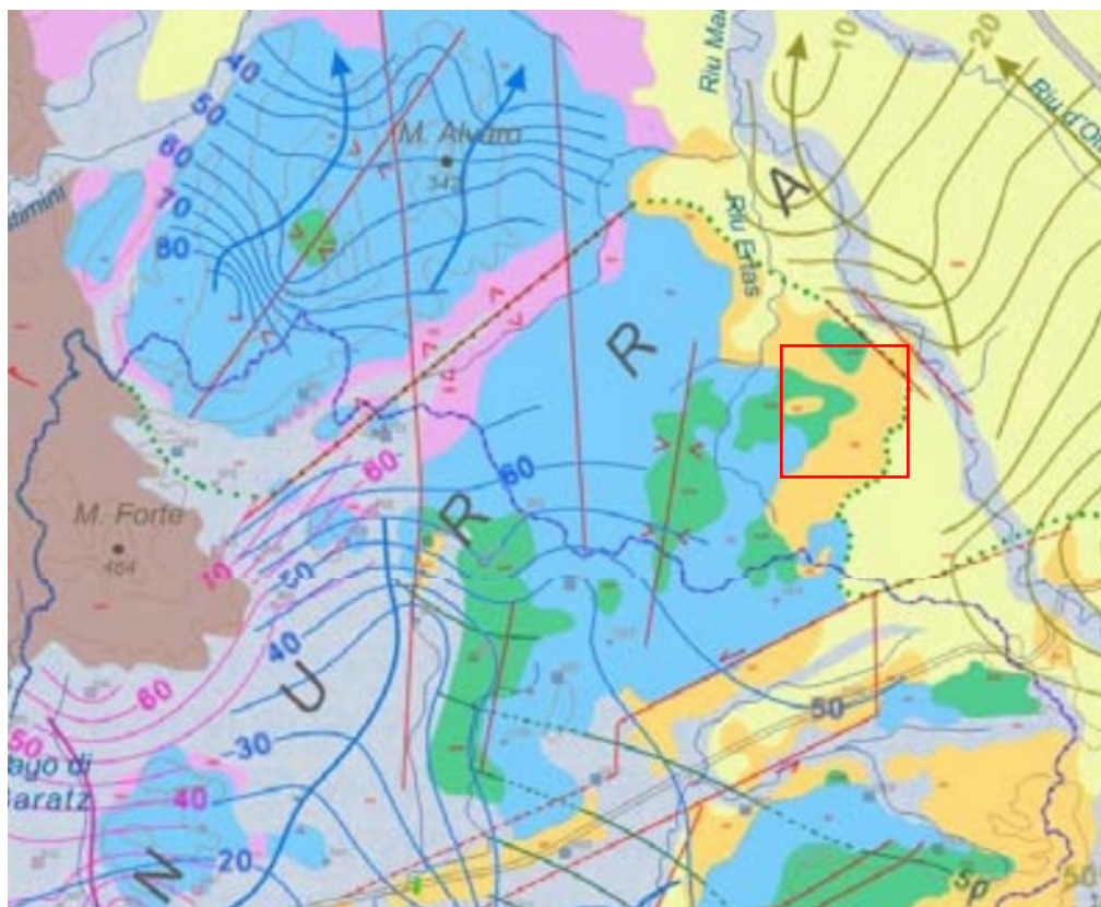
Figura 9 - Carta idrogeologica e rete di monitoraggio corpi idrici superficiali e sotterranei Nurra
