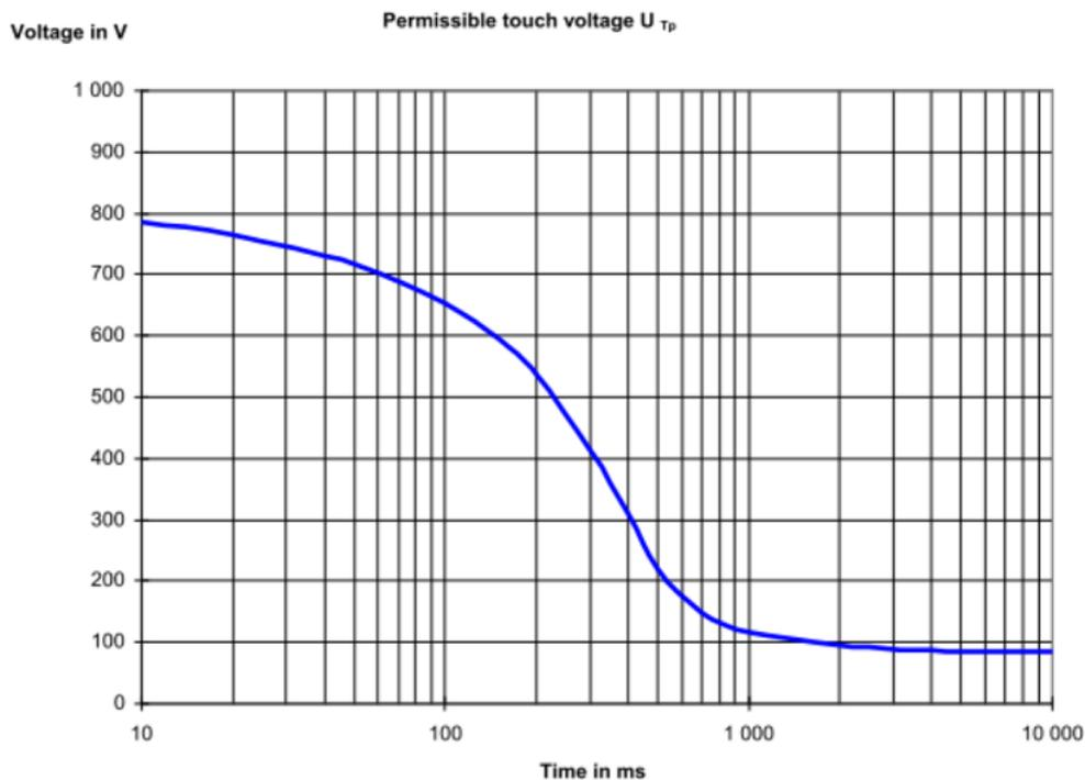
Tale limite, confrontato con la tensione totale di terra  $U_T$  (cioè con il GPR) impone una resistenza di terra minima di progetto  $R_T$  per la risoluzione dei guasti MT di:
