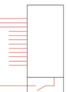
inverter (Huawei) 215kVA (output :200kW); efficienza 99%; 9 Mppt ; Vmax 1.500V; Vn (Mppt) :500-1500V; Vn= 1.080V ; Vout= 800V 3ph+PE; In 30A\*9; Icc=50\*9; Interruttore di sezionamento 250A
