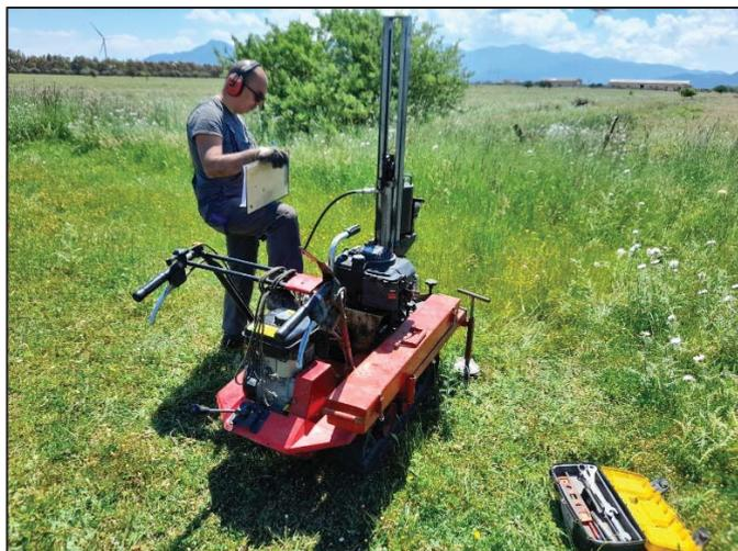
*Figura 12: penetrometro medio utilizzato posizionato su cingoli sul punto della prova penetrometrica DIN 2.*
