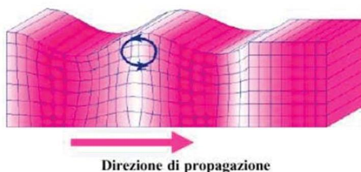
**Rappresentazione grafica della propagazione delle onde superficiali di Rayleigh caratterizzata dall'oscillazione polarizzata in un piano verticale e con movimento delle particelle retrogrado rispetto al senso di propagazione dell'onda.**
