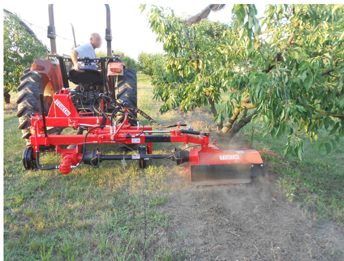
Figura 6.1: Esempio di fresatrice interceppo per le lavorazioni sulla fila (Foto: Cucchi Macchine Agricole)
