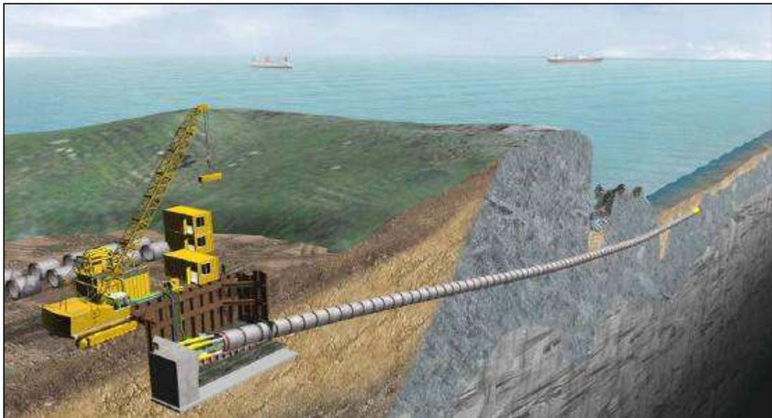
**Fig. 3.2.1: Costruzione del microtunnel sottomarino (Estratto da: "Trenchless installation methods of Sea Outfalls")**
