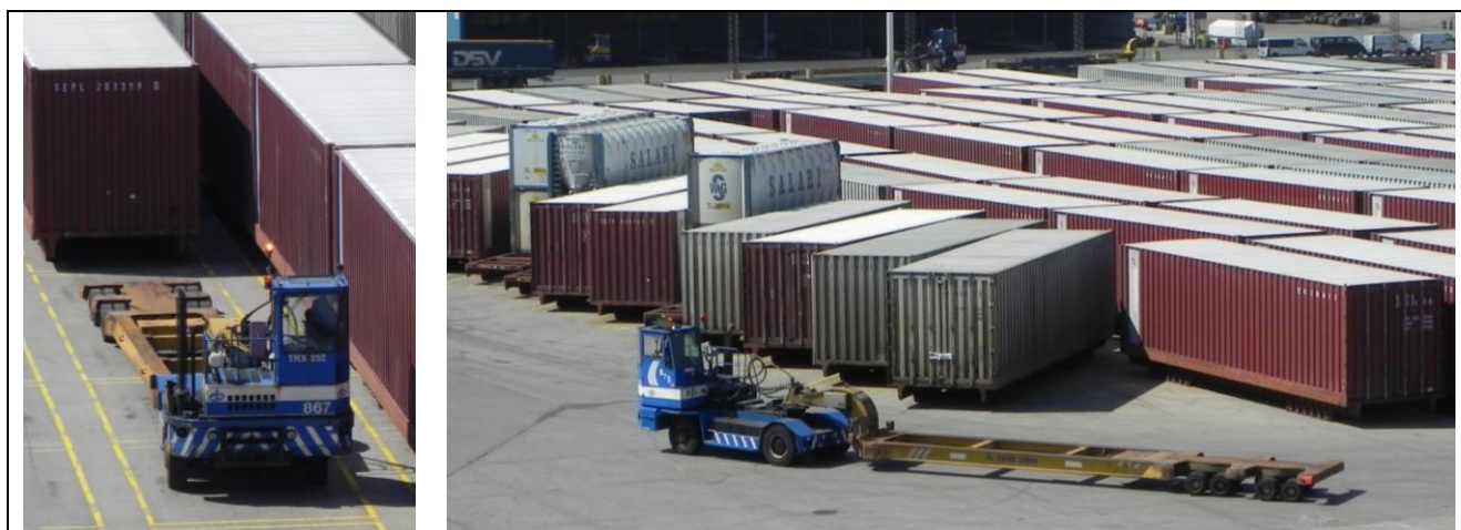
Figura 3.6. Tractor e trailer per la movimentazione dei container
