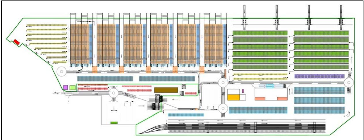
Figura 3.7. Planimetria terminal container ad elevata automazione
