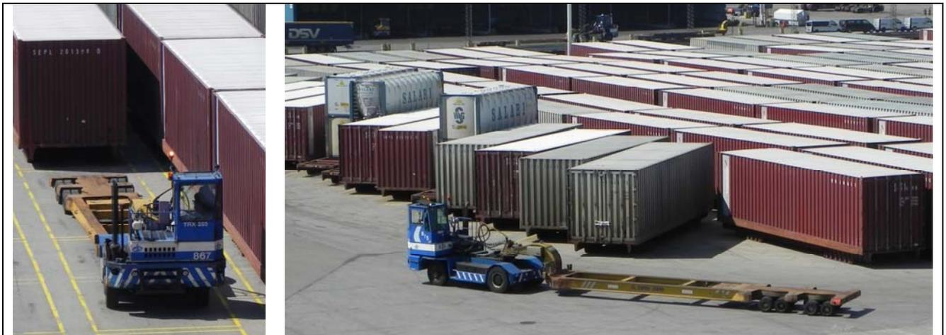
Figura 3.5. Tractor e trailer per la movimentazione dei container
