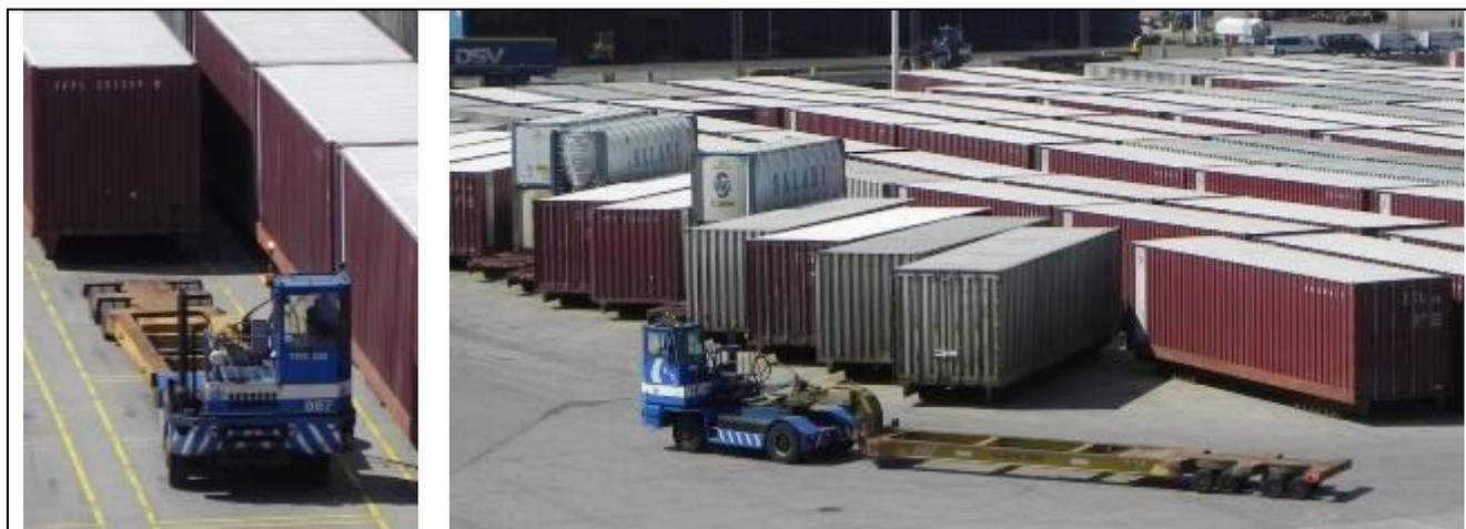
Figura 2.31. Tractor e trailer per la movimentazione dei container.
