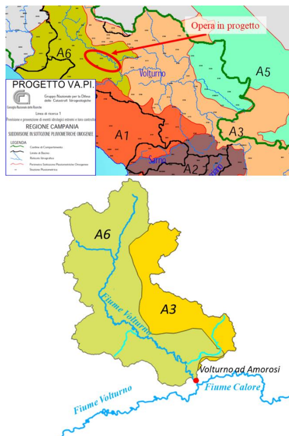
Figura 3.2 – Sottozone omogenee (VAPI Campania, alto); dettaglio del bacino del Fiume Volturno ad Amorosi
