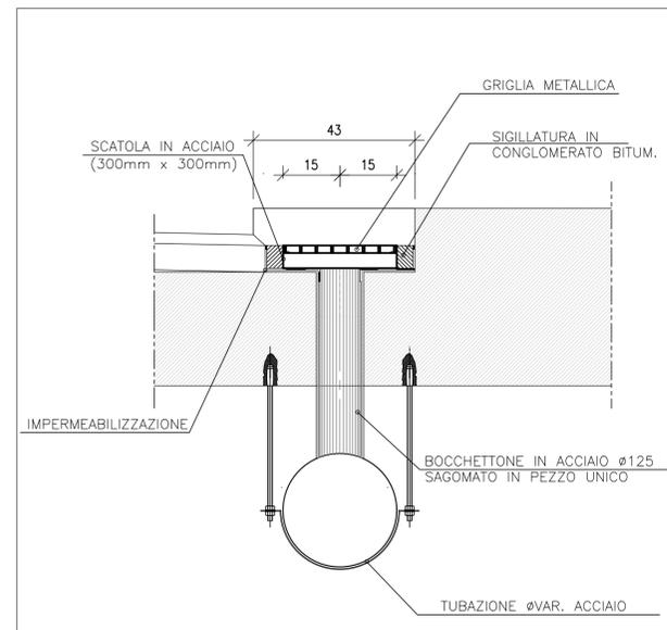
DRENAGGIO DI PIATTAFORMA CON SEZIONE IN VIADOTTO:
