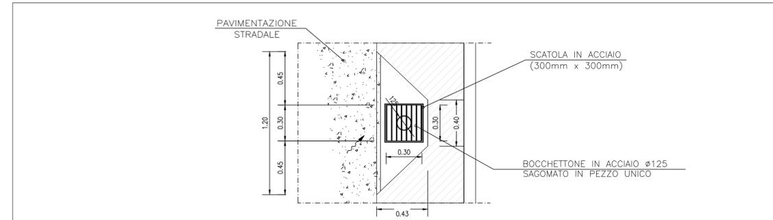
DRENAGGIO DI PIATTAFORMA CON SEZIONE IN VIADOTTO:
