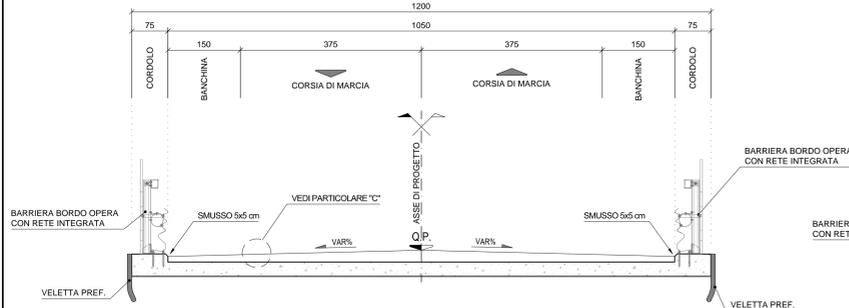
SEZIONE TRASVERSALE CAVALCAVIA VIABILITA' SECONDARIA
