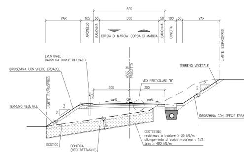
SEZIONE TIPO ROTATORIA VIABILITÀ MINORI
