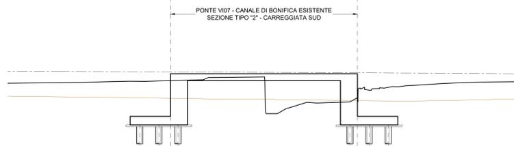
Nota: si prevede la demolizione integrale degli impalcati e delle sottostrutture esistenti fino a quota estradosso plinti di fondazione. Nel caso di interferenza tra fondazioni di nuova realizzazione e fondazioni esistenti si prevede la demolizione integrale del plinto esistente fino a quota intradosso.
