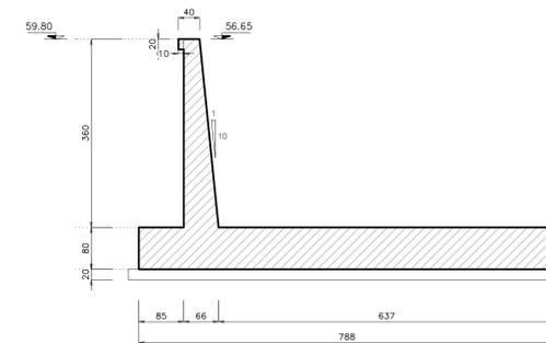
SEZIONE LONGITUDINALE A - A scala 1:100
