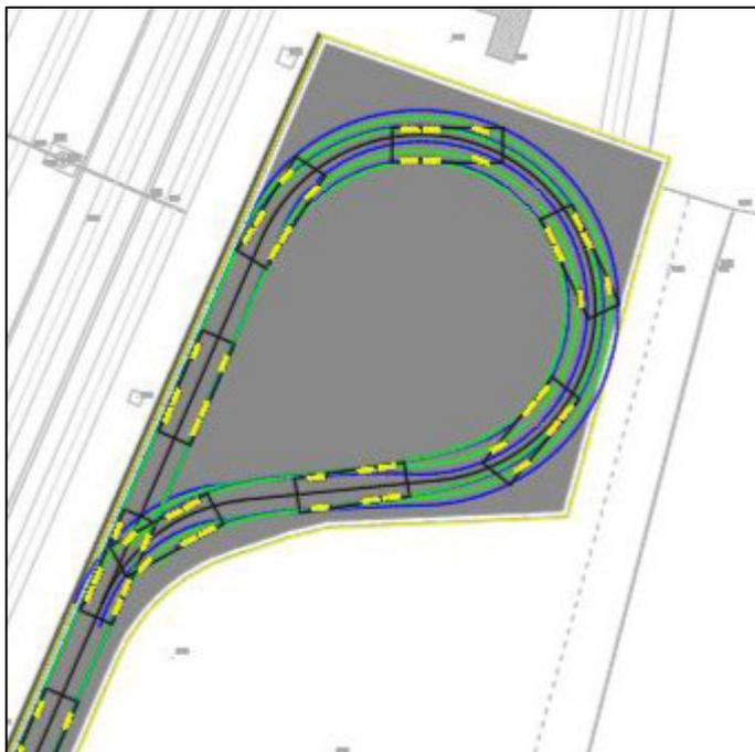
**Figura 6** – Viabilità di accesso mezzi di soccorso – Dettaglio area di manovra
